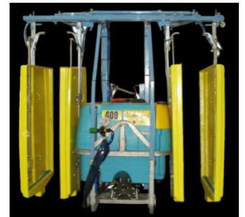
S21 - Panneaux récupérateurs
