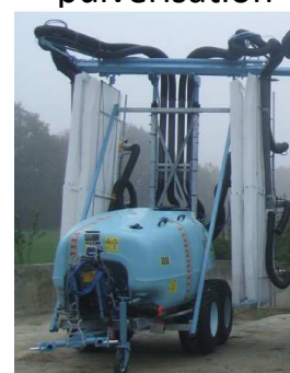
S21 – Tunnel de pulvérisation
