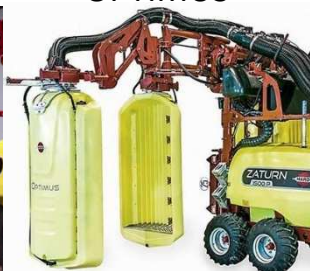
HARDI - panneaux récupérateurs OPTIMUS
