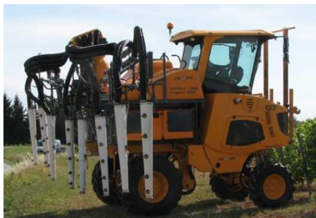
GREGOIRE - ISO OPTIMA/ULTIMA avec rampe jet porté
