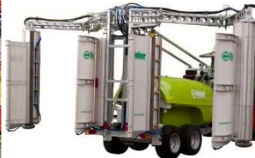
WEBER – descentes avec panneaux récupérateurs
